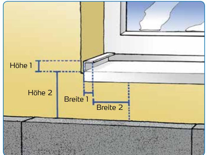
Für eine korrekte Einpassung der Dämmplatte am Fensterbank-Anschluss müssen vier Maße an der Fassade abgenommen werden
