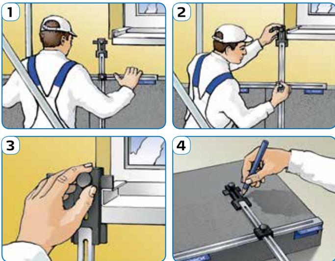
STORCH ISO MARK ermöglicht die einfache Übernahme der genauen Maße auf die WDVS-Platte
