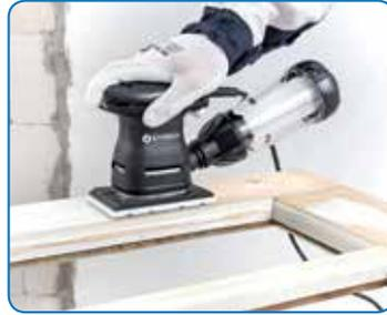
Für flächigen Grob- und Zwischenschliff kleiner und mittlerer Flächen.
